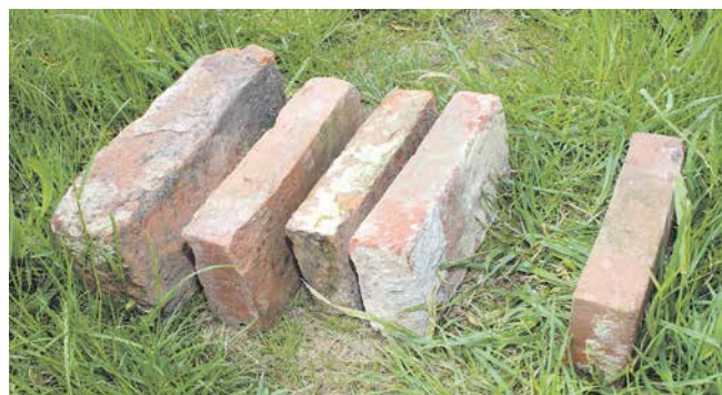
Maurermeister Andreas Arends arbeitet derzeit an der Fassade einer alten Pastorei von 1729 in Emden. Anhand der Optik der Backsteine und des Materials kann Arends die jeweilige Epoche zuordnen. Auf dem kleinen Bild ist der älteste Backstein auf der linken Seite. Er ist ca. 600 Jahre alt. Rechts der jüngste Backstein, er ist ca. 150 Jahre alt.
