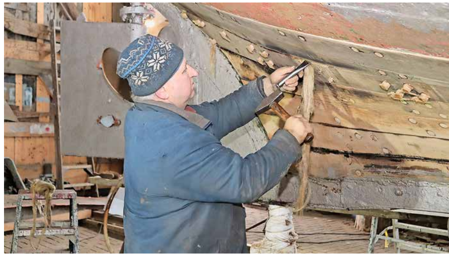
Bootsbauermeister Gerjet Bültjer (Senior) zeigt, wie die Plankengänge kalfatert (abgedichtet) werden. Eine zeitaufwendige Arbeitsweise, die nicht mehr auf vielen Werften gepflegt wird.
